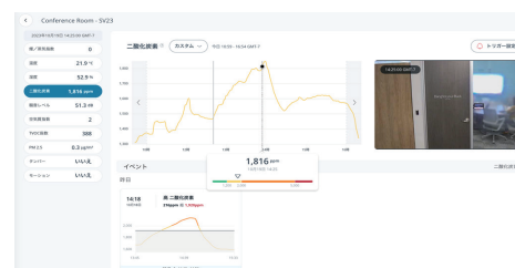
空気質センサーとカメラの統合
